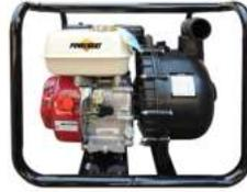
Motor POWERCAT 4 tiempos OHV, 7 hp, 209 cc, succión/descarga 2"x2", succión máxima 8 metros, altura máxima 30 metros, caudal máximo 36 m<sup>3</sup>/hr, bomba para químicos de propileno, autocebante, peso 24 kg.
