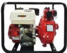
Motor SHIRAIWA 4 tiempos OHV, 7.5 hp, 270 cc, succión/descarga 2"x2", succión máxima 8 metros, altura máxima 55 metros, caudal máximo 20 m<sup>3</sup>/hr, peso 27 kg.
