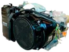
Motor 4 tiempos OHV, 15hp, 420 cc, 3600 rpm, arranque manual, alerta de aceite, eje 25.4 mm, flecha horizontal cónica para generador PWC 6500-7500, peso 30 kg.
