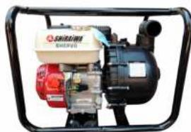
Motor SHIRAIWA 4 tiempos OHV, 7 hp, 209 cc, succión/descarga 2"x2", succión máxima 8 metros, altura máxima 30 metros, caudal máximo 36 m<sup>3</sup>/hr, bomba para químicos de propileno, autocebante, peso 24 kg.
