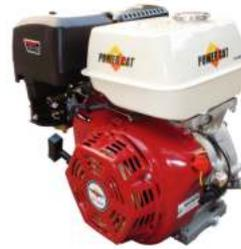
Motor 4 tiempos OHV, 13 hp, 389 cc, 3600 rpm, arranque eléctrico, alerta de aceite, eje 25.4 mm, flecha horizontal, peso 35 kg.
