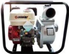
Motor SHIRAIWA 4 tiempos OHV, 6.5/7.5 hp, succión/descarga 3"x3", succión máxima 8 metros, altura máxima 28 metros, caudal máximo 60 m<sup>3</sup>/hr, peso 45 kg.
