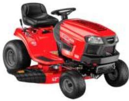
Motor BRIGGS & STRATTON, 17.5 hp, diámetro de corte 42", 2 cuchillas. Tanque de combustible 5.6 litros, asiento de espalda baja, manual 7 velocidades, llanta delantera 15x6, trasera 20x8. Bolsa recolectora opcional. (sin batería), peso 150 kg.
