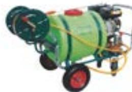
Base con tanque de 100 litros, motor POWERCAT 4 tiempos, 6.5 hp, 190 cc. Incluye portamanguera, manguera de 30 metros, 800/1200 rpm, succión 8 metros, con sensor de aceite, bomba con pistones de cerámica, llantas neumáticas, peso 65 kg.
