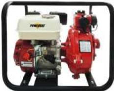
Motor POWERCAT 4 tiempos OHV, 7.5 hp, 270 cc, succión/descarga 2"x2", succión máxima 8 metros, altura máxima 55 metros, caudal máximo 20 m<sup>3</sup>/hr, peso 27 kg.
