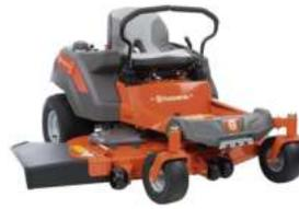
Motor KOHLER / BRIGGS & STRATTON, KAWASAKI, 2 cilindros V-TWIN, 26 hp, 747 cc, diámetro de corte 54". Transmisión hidrostática, 3 cuchillas de corte, tanque de combustible 15 litros, asiento de espalda baja. Bolsa recolectora opcional. (sin batería), peso 250 kg.
