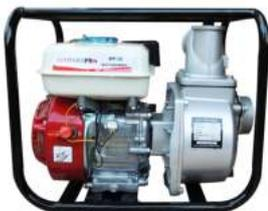
Motor SHIMAHA 4 tiempos OHV, 6.5 hp, 196 cc, succión/descarga 3"x3", succión máxima 8 metros, altura máxima 30 metros, caudal máximo 60 m<sup>3</sup>/hr, peso 30 kg.
