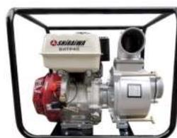
Motor SHIRAIWA 4 tiempos OHV, 15 hp, 430 cc, succión/descarga 4"x4", succión máxima 8 metros, altura máxima 30 metros, caudal máximo 96 m<sup>3</sup>/hr, bomba tragasólidos, autocebante, peso 43 kg.
