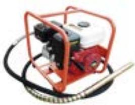
Motor POWERCAT 4 tiempos, 6.5 hp, chicote de 38 mm de 4 ó 6 metros, sistema de péndulo, 3600 rpm, sensor de aceite, doble placa para golpe, peso 44 kg.
