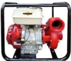
Motor POWERCAT 4 tiempos OHV, 15 hp, 430 cc, succión/descarga 3"x3", succión máxima 8 metros, altura máxima 85 metros, caudal máximo 40.4 m<sup>3</sup>/hr, impulsor de caracol, peso 45 kg.
