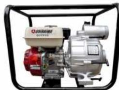
Motor SHIRAIWA 4 tiempos OHV, 7.5 hp, 270 cc, succión/descarga 3"x3", succión máxima 8 metros, altura máxima 30 metros, caudal máximo 60 m<sup>3</sup>/hr, bomba tragasólidos, autocebante, peso 37 kg.
