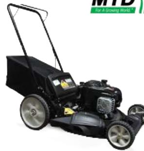
Motor Briggs & Stratton, 140 cc, corte de 21", 3 en 1, descarga lateral (6 posiciones), llanta trasera alta 11", bolsa recolectora, peso 30 kg.
