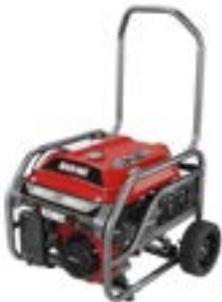
Motor TTI 4 tiempos OHV, 208 cc, motor digital 4 en 1, 3600 w continuos, 4500 w pico, 120 v. Capacidad del tanque 22,7 litros, 10 horas de trabajo continuo, sistema de regulación de voltaje AVR, peso 50 kg.
