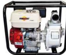
Motor POWERCAT 4 tiempos OHV 6.5/7.5 hp, succión/descarga 2"x2", succión máxima 8 metros, altura máxima 28 metros, caudal máximo 30 m<sup>3</sup>/hr, peso 26 kg.
