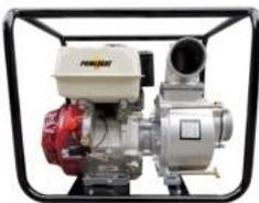
Motor SHIRAIWA 4 tiempos OHV, 13 hp, 430 cc, succión/descarga 4"x4", succión máxima 8 metros, altura máxima 30 metros, caudal máximo 96 m<sup>3</sup>/hr, peso 52 kg.
