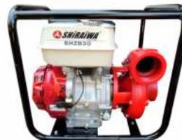
Motor SHIRAIWA 4 tiempos OHV, 15 hp, 430 cc, succión/descarga 3"x3", succión máxima 8 metros, altura máxima 85 metros, caudal máximo 40.4 m<sup>3</sup>/hr, impulsor de caracol, peso 45 kg.
