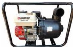
Motor SHIRAIWA 4 tiempos OHV, 7.5 hp, 270 cc, succión/descarga 3"x3", succión máxima 8 metros, altura máxima 30 metros, caudal máximo 60 m<sup>3</sup>/hr, bomba para químicos de propileno, autocebante, peso 28 kg.
