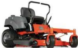
Motor KOHLER / BRIGGS & STRATTON, 2 cilindros V-TWIN, 23 hp, 725 cc, diámetro de corte 46". Transmisión hidrostática, tanque de combustible 13 litros, asiento de espalda baja. Bolsa recolectora opcional. (sin batería), peso 250 kg.
