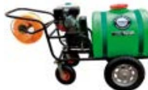
Base con tanque de 160 litros, motor SHIRAIWA 4 tiempos, 6.5 hp, 190 cc. Incluye portamanguera, manguera de 50 metros, 800/1200 rpm, succión 8 metros, con sensor de aceite, bomba con pistones de cerámica, llantas neumáticas, peso 80 kg.
