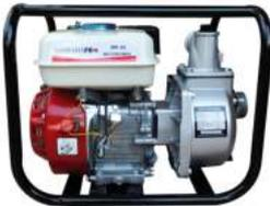
Motor SHIMAHA 4 tiempos OHV, 6.5 hp, 196 cc, con sensor de aceite, succión/descarga 2"x2", succión máxima 8 metros, altura máxima 30 metros, caudal máximo 21 m<sup>3</sup>/hr, peso 23 kg.
