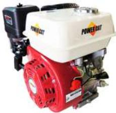
Motor 4 tiempos OHV, 7.5 hp, 230 cc, 3600 rpm, arranque manual, alerta de aceite, eje 19.04 mm, flecha horizontal, peso 17 kg.
