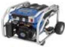
Motor SUBARU EX40 4 tiempos OHV, 14 hp, 220 cc, 7000 w continuos, 8700 w pico, 120-240 v. Capacidad del tanque 15 litros, 10 horas de trabajo continuo, arranque eléctrico, peso 110 kg.
