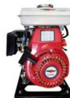
Motor POWERCAT 4 tiempos OHV, 2.5 hp, succión/descarga 1"x1", succión máxima 8 metros, altura máxima 10 metros, caudal máximo 5 m<sup>3</sup>/hr, peso 11 kg.
