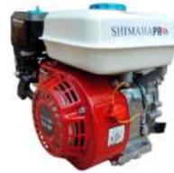
Motor 4 tiempos OHV, 6.5 hp, 196 cc, 3600 rpm, arranque manual, alerta de aceite, eje 19.04 mm, flecha horizontal, peso 16 kg.
