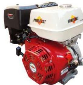
Motor 4 tiempos OHV, 15hp, 420 cc, 3600 rpm, arranque manual y eléctrico, alerta de aceite, eje 25.4 mm, flecha horizontal, peso 37 kg.
